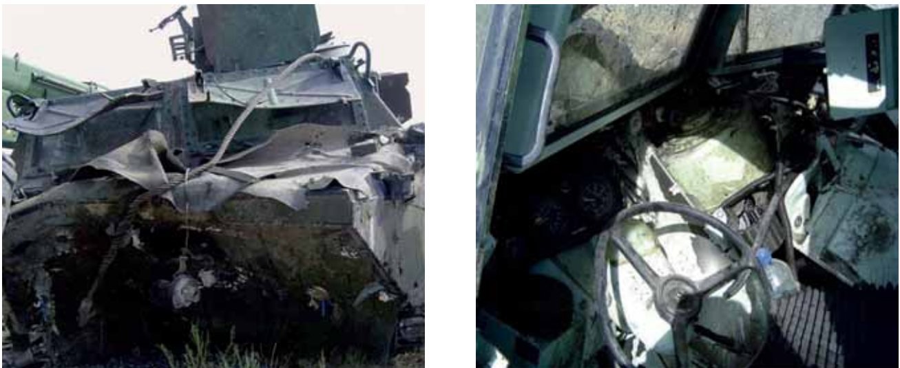
Figure 6. Véhicule de l'avant blindé ayant sauté sur un EEI: la forme en V de la caisse avant a permis de dévier le souffle de l'explosion et de limiter les dégâts à l'intérieur de l'habitacle.
