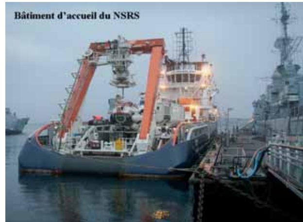
Figure 3. Bâtiment d'accueil du NSRS, avec sous-marin de sauvetage SRV disposé sur le portique.
