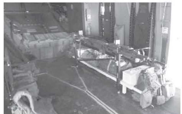
Figure 7. Soute de NH 90 Caïman avec le châssis temporaire pour la fixation du matériel médical.
